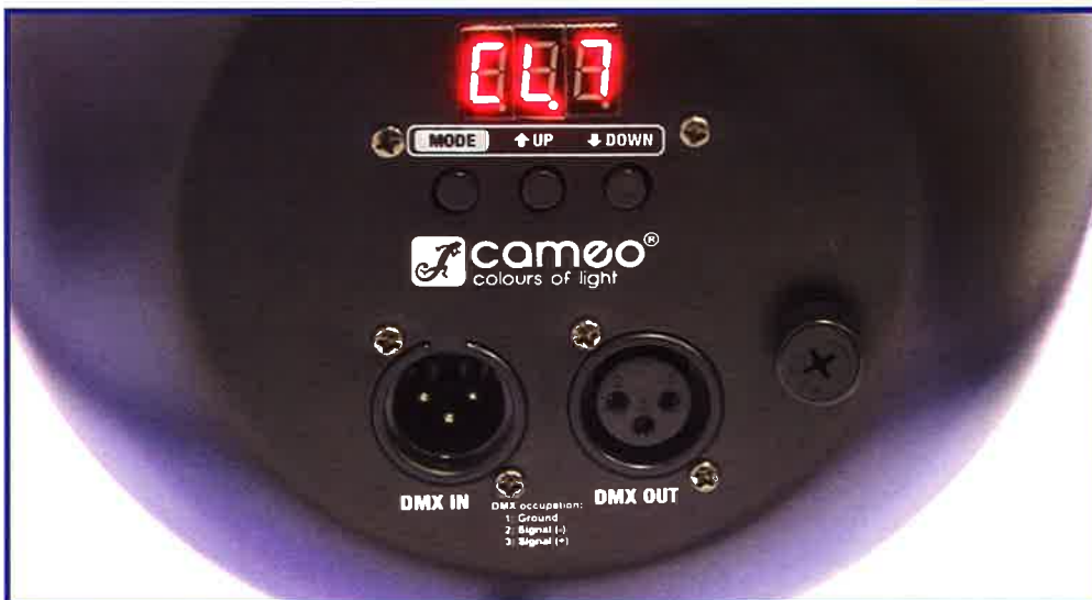
Die einzelnen Betriebs-Modi können über ein kleines Display und drei Tasten eingestellt werden
